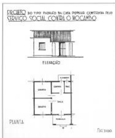
Imagem 1: Desenhos de casas populares padrão projetadas para a população removida dos mocambos no Recife, anos 1940 (sem escala) (fonte: Correia, 2004)
