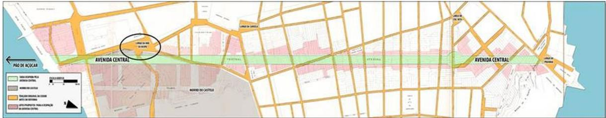
Figura 3. Traçado da Avenida Central, 1904. Em cinza, os limites dos morros do Castelo e São Bento. Em amarelo, as vias existentes antes da abertura da Avenida, marcada em verde. Em rosa, os lotes desapropriados e demolidos para dar lugar à nova Avenida. Em destaque no círculo o espaço onde se formaria a Praça Floriano. Fonte: MATTOS, 2010, p.38.
