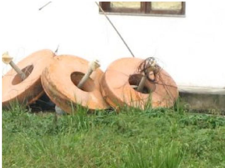
Figura 5: Aeradores fora de funcionamento na ETE Aeroporto.
