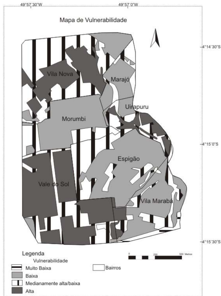
Figura 9: Mapa de vulnerabilidade a inundações da sede do município de Novo Repartimento (PA).
