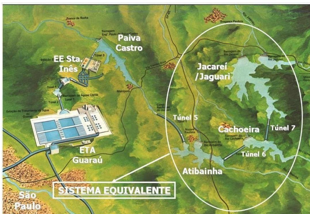
Fig. 01 – Desenho esquemático do Sistema Cantareira. Fonte: Sabesp, 2006.
